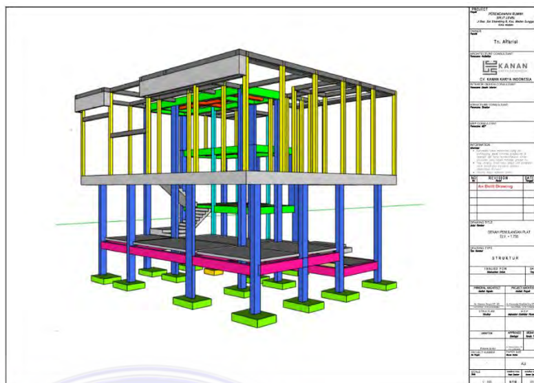
Gambar 42. Pengerjaan As Built struktur Perencanaan Rumah Split
