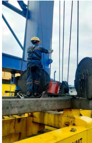
Gambar 3. 19. proses Meminyaki ( Lubrication ) tali Kawat Baja ( Wirerope ).
