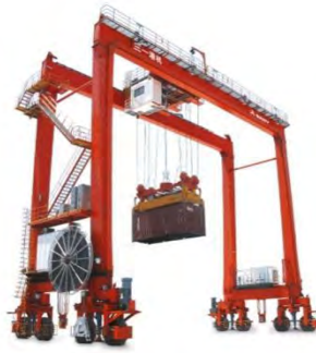
Gambar 3. 7. Support Leg pada Rubber Tyred Gantry Craner
