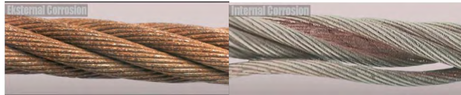
Gambar 3.14. korosi eksternal dan internal
