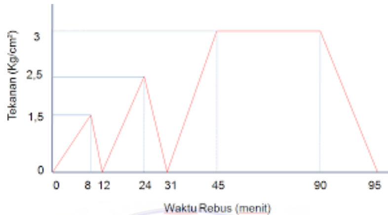
Gambar 3. 15 . Grafik sistem perebusan tiga puncak (triple peaks)
