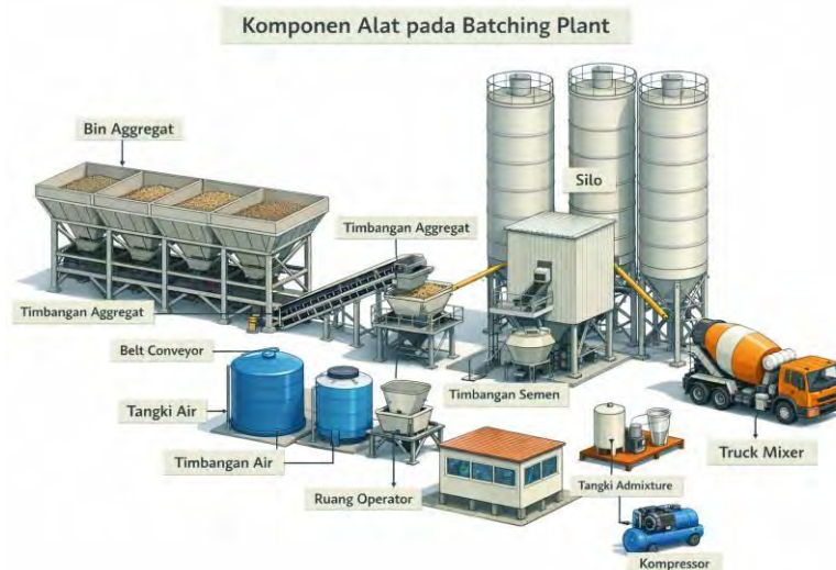
Gambar 3.1. Bagan Alir Proses Produksi Di Batching Plant
