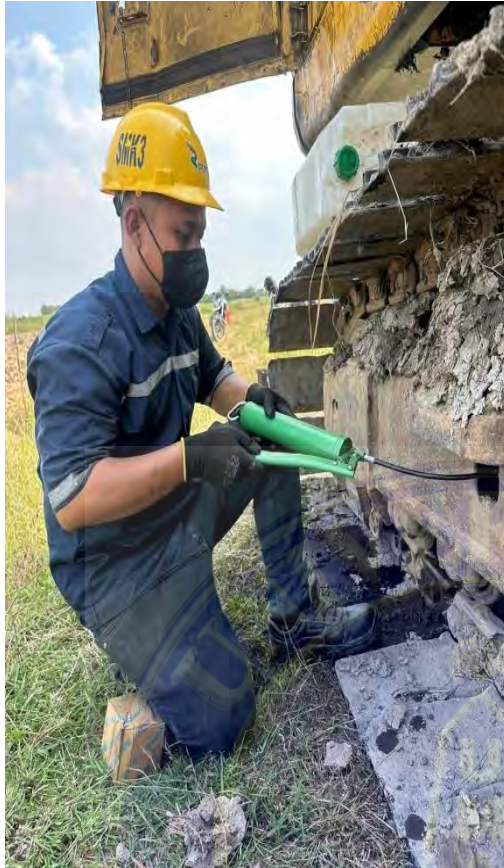
Proses Grease Pada Track
