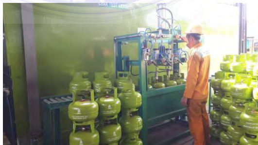
Gambar 3. 12 Stasiun Leak Test Akhir
