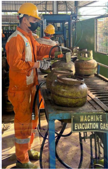
Gambar 3. 2 Stasiun Purgung Gas
