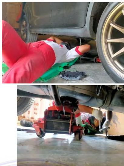
Gambar 3.37 proses penurunan tangki
