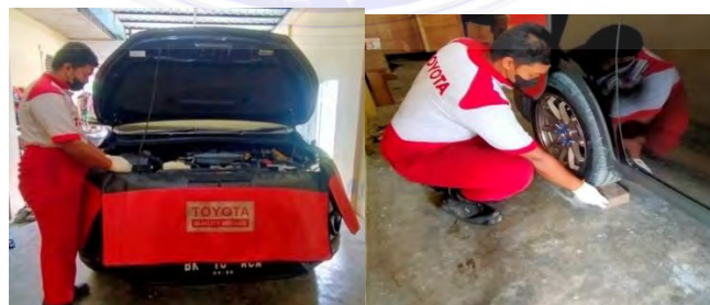
Gambar 3.25 pemasangan fender cover&ganjal roda
