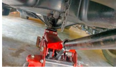
Gambar 3.33 proses mendongkrak kendaraan
