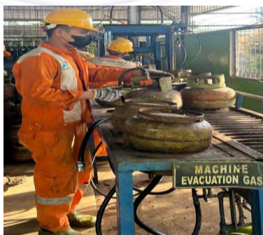
Gambar 3.2 Stasiun Purging Gas
