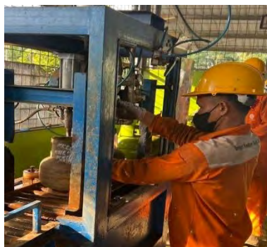
Gambar 3.4 Stasiun Leak Test Awal
