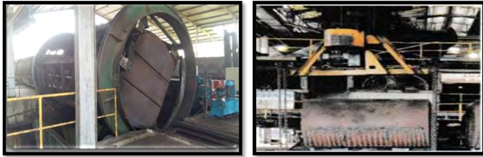
Gambar 3.10. Hoisting Crane dan Tippler
