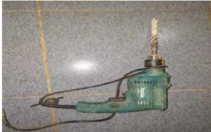
Gambar 3.19 Bor Tangan (Dokumentasi Proyek, 2026)
