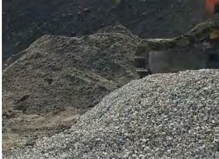
Gambar 3.25 Pasir beton (Dokumentasi Proyek, 2026)
