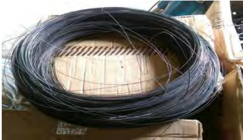
Gambar 3.22 Kawat bendrat (Dokumentasi Proyek, 2026)
