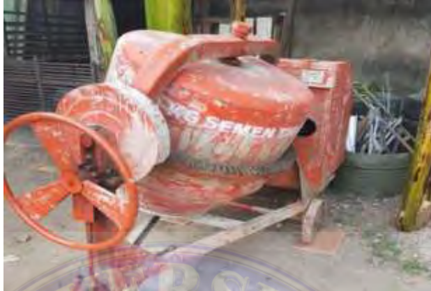
Gambar 3.15 Concrete Mixer (Dokumentasi Proyek, 2026)
