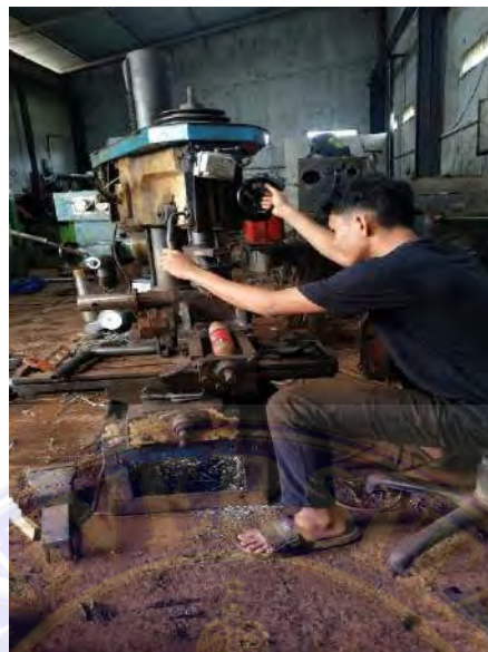
Gambar 3.29 Mengatur posisi mata bor ke titik pengeboran
