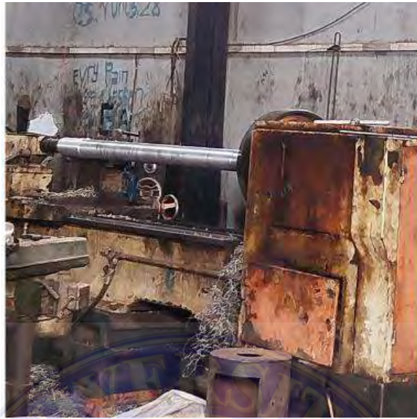
Gambar 3. 11 Benda Kerja Sebelum Proses Drilling
