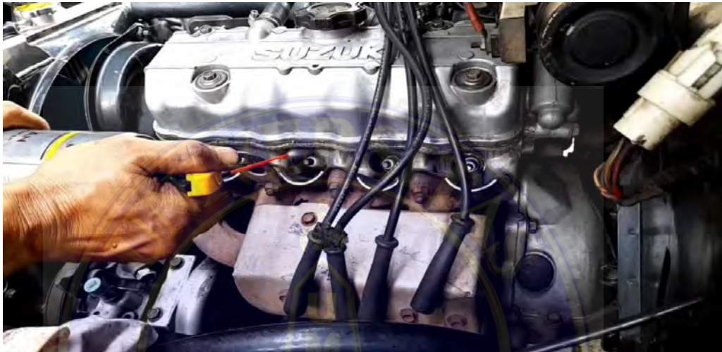
Gambar 3.24. Melepas Kabel Busi
