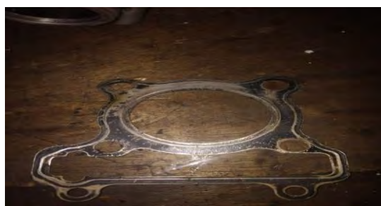
Gambar 3. 6 Gasket kepala silinder
