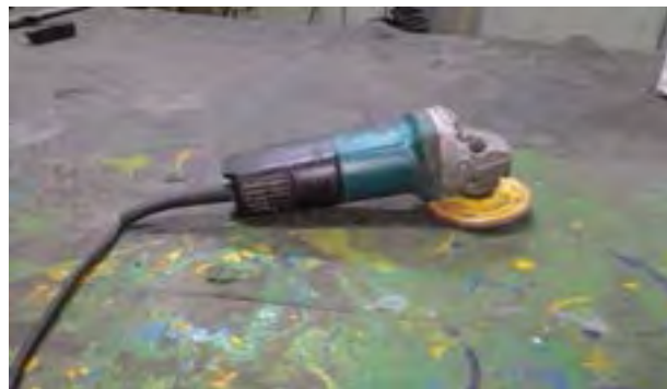
Gambar 3.12 Gerinda Tangan (Dokumentasi Proyek, 2
