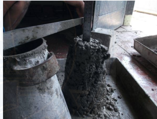
Pengukuran Slump dengan 10% Tempurung
