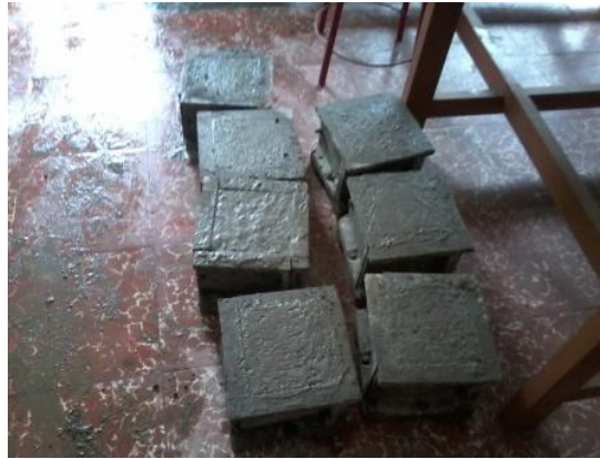
Hasil Pengecoran benda uji
