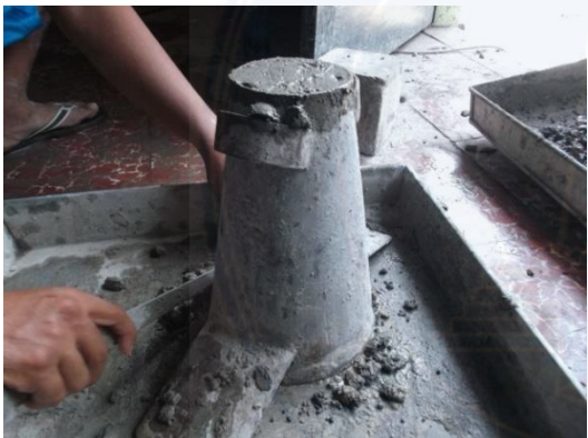
Pemadatan Beton dengan 10% Tempurung
