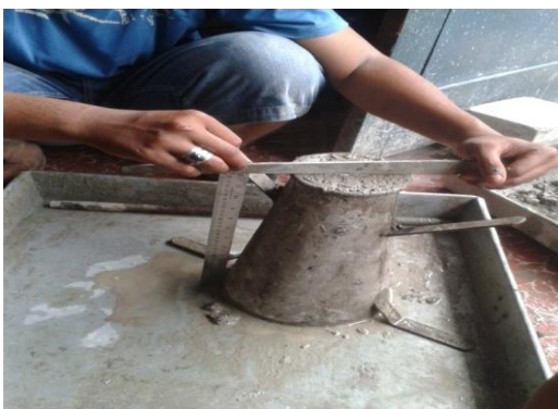
Pemadatan Beton dengan 20% Tempurung
