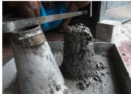
Pengukuran Slump dengan 20% Tempurung
