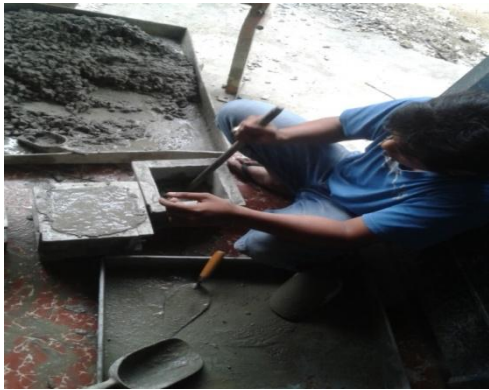
Pengecoran Benda Uji Tempurung
