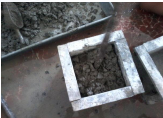
Pengecoran Benda Uji sebanyak 20 benda uji
