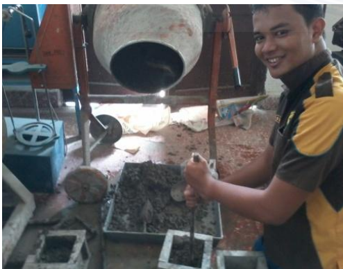
Pengecoran Benda Uji 15 x 15 x 15 cm
