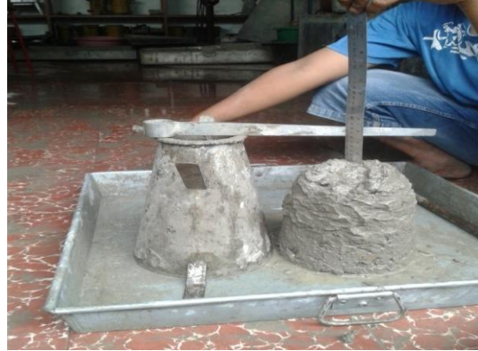
Pengukuran Slump dengan 30% Tempurung
