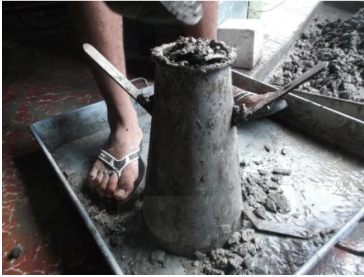
Pemadatan Beton Normal
