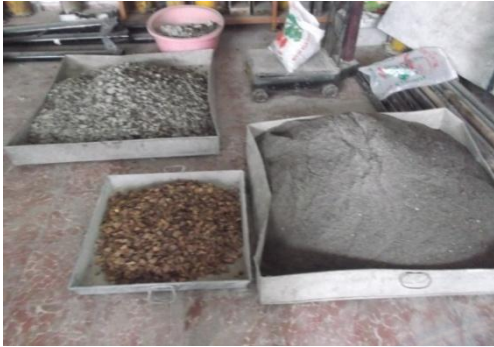
Komposisi Agregat dengan Tempurung 10%
