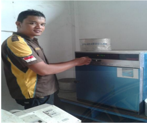
Pengeringan Benda Uji dalam Oven 24 Jam
