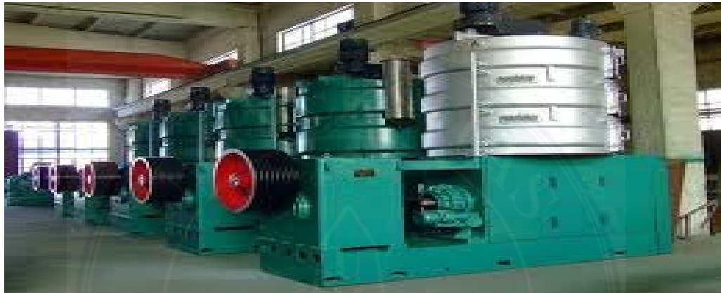
Gambar 2.4. (a). Degester, dan (b). Screw Press
