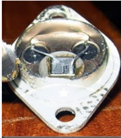
Gambar 2.6 : Transistor 2N3055 (isi dalamnya)
