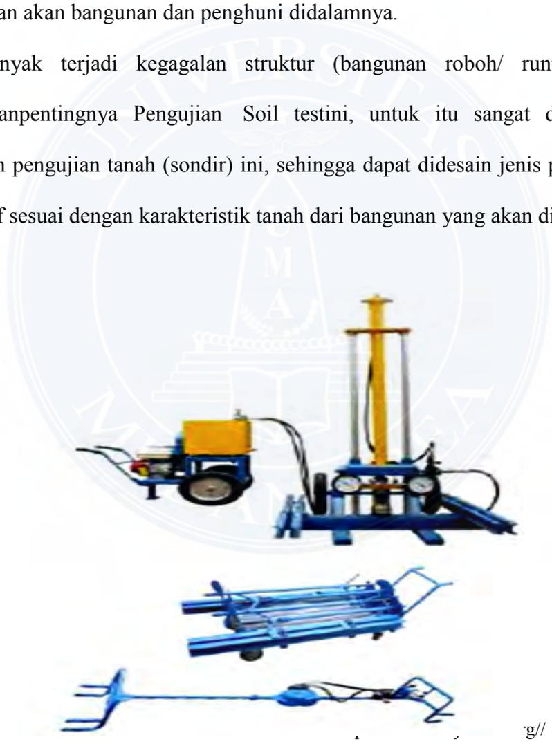
Sondir adalah alat berbentuk silindris dengan ujungnya berupa konus. Biasanya dipakai adalah bi-conus type Begemann yang dilengkapi dengan selimut/jacket untuk mengukur hambatan pelekat lokal (side friction) dengan dimensi sbb :
