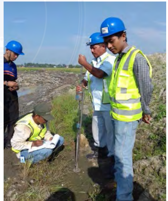
Gambar .1. pengujian alat DCP pada tanah gambut
