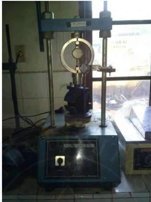
Gambar 3.2. Alat Uji Marshall Sumber : Data Lapangan Lab. PT. Karya Murni
