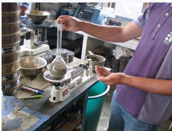
Menimbang agregat yang sudah dimasukkan ke dalam botol dengan berat 500 gram
