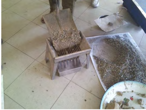
Menyaring agregat batu pecah 1/2 dengan saringan kasar
