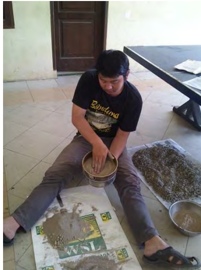
Gradasi filler abu vulkanik dengan saringan no.200
