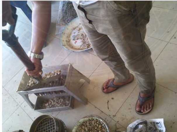
Menyaring agregat Batu Pecah 3/4 dengan saringan kasar
