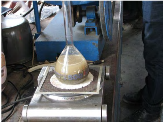
Botol yang sudah berisi agregat dan air di masak hingga mendidih
