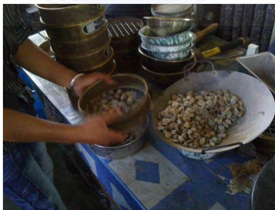
Gradasi agregat yang sudah dikeringkan
