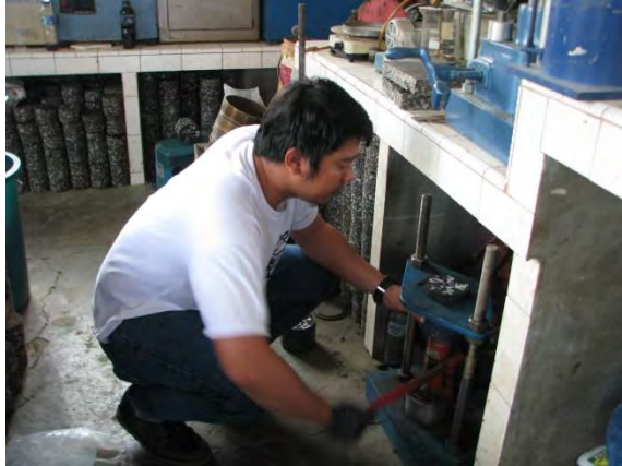
Membuka benda uji yang sudah dipadatkan
