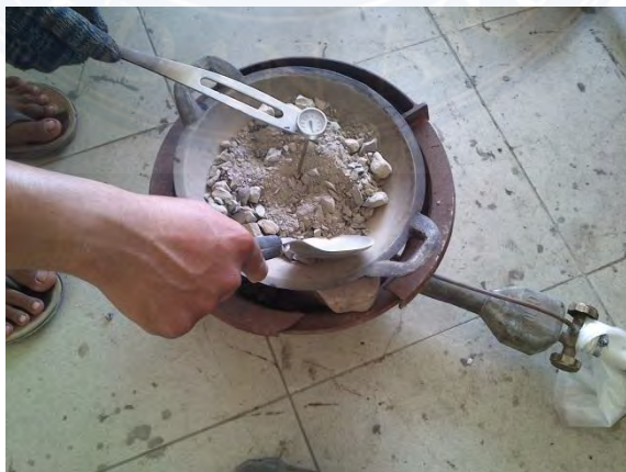
Agregat yang sudah digabung dipanaskan dengan suhu 150 °C
