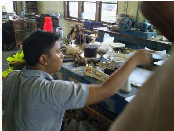
Menimbang agregat yang sudah dipadatkan
