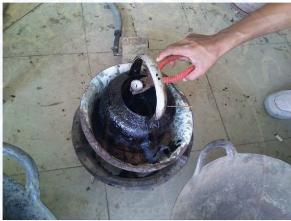
Memanaskan aspal dengan suhu 160 °C
