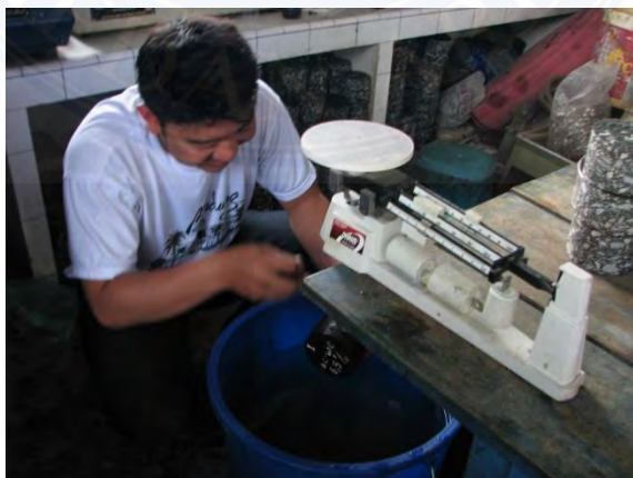
Menimbang benda uji didalam air
