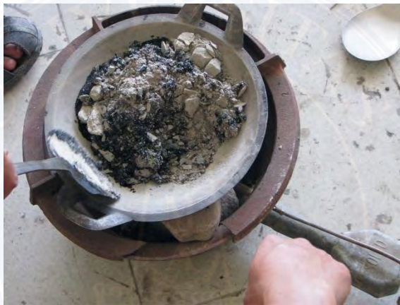
Agregat yang sudah dicampur dengan aspal dipanaskan lagi dengan suhu 150 °C
