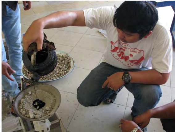
Agregat yang sudah dipanaskan dicampur dengan aspal
