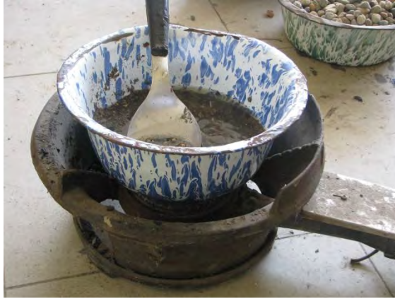
Mengeringkan agregat yang sudah dicuci bersih untuk mencari SPGR agregat halus dengan menggunakan kompor gas
