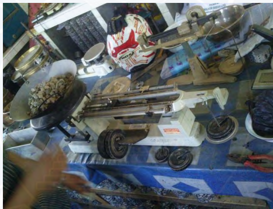
Menimbang agregat yang sudah dikeringkan
