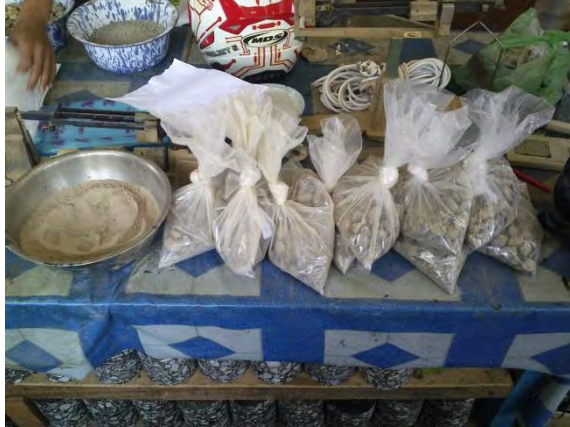
Agregat yang sudah dicampur dibungkus plastik agar tidak berserakan
