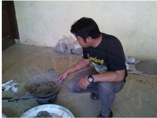
Mengeringkan benda uji dengan cara dipanaskan dengan kompor gas
