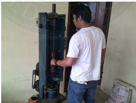
Memadatkan benda uji yang sudah dipanaskan dengan alat hammer test
