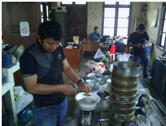
Mencampur semua agregat dengan komposisi yang sudah ditentukan
