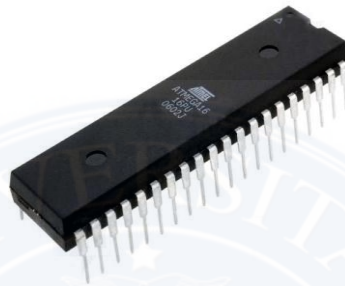
Gambar 2.1 Bentuk Fisik Mikrokontroler ATMEGA 16 ( Sumber :20 Aplikasi mikrokontroler ATmega8535 & ATmega8535 menggunakan Bascom-AVR, Afrie Setiawan)
