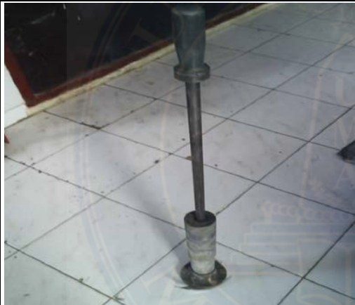
Penumbuk Benda uji Marshall
