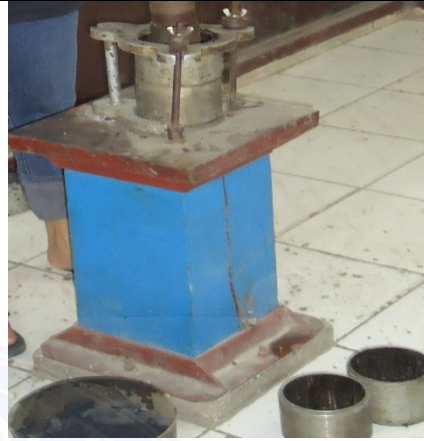
Cetakan benda uji Marshall dan landasan pematatnya
