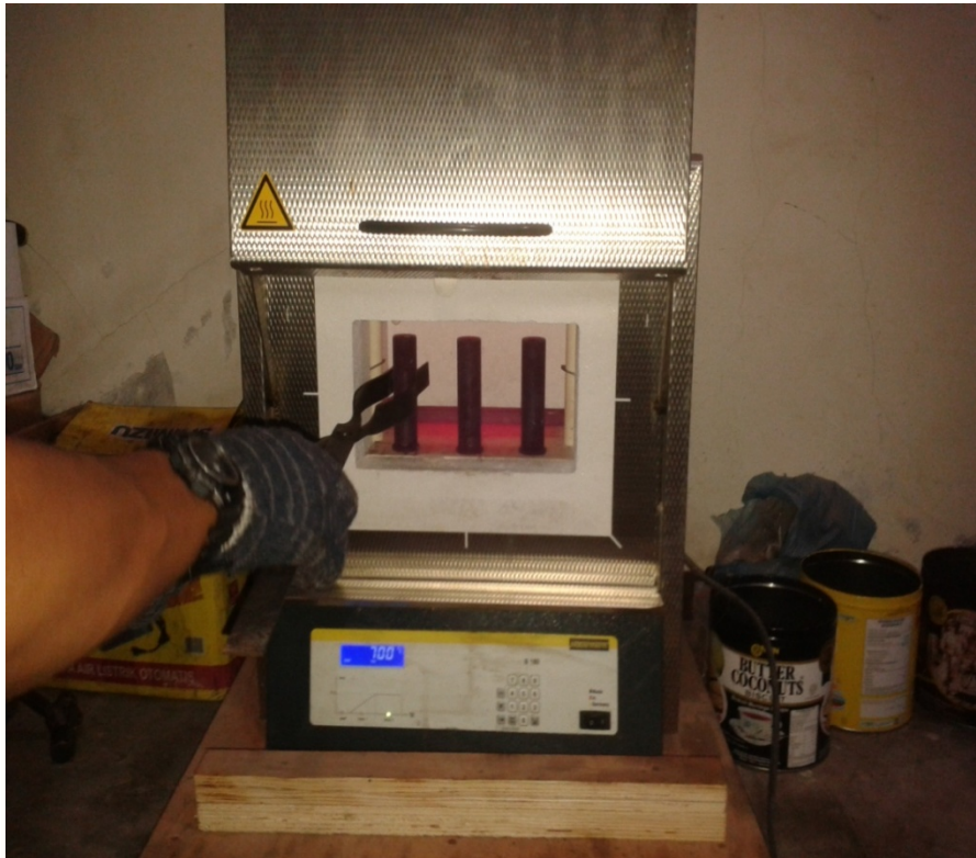
Gambar : 2.4 Proses Perlakuan Panas pada benda uji baja NS - 1045
