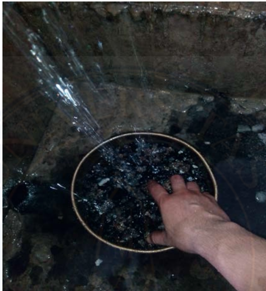
Gambar 3.1 Mengaduk Bottom Ash
