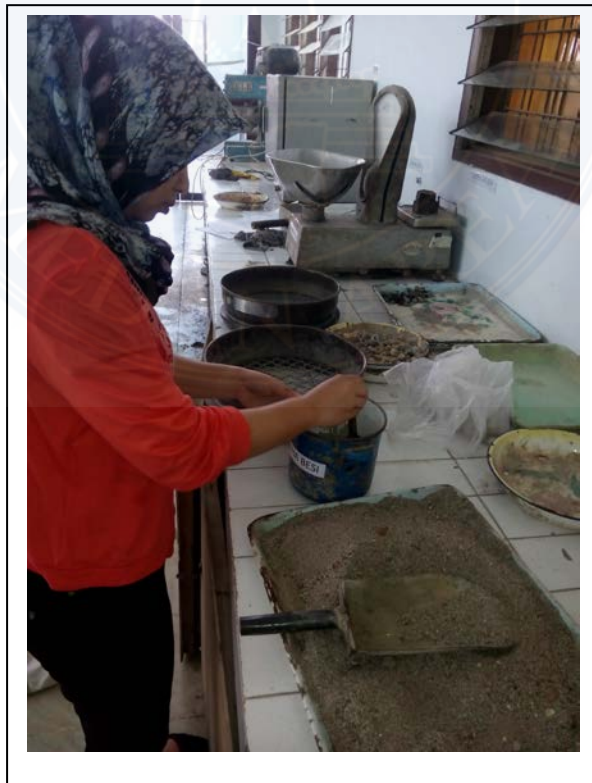
Gambar 3.6 Mengisi benda uji (bottom ash) ke dalam wadah
