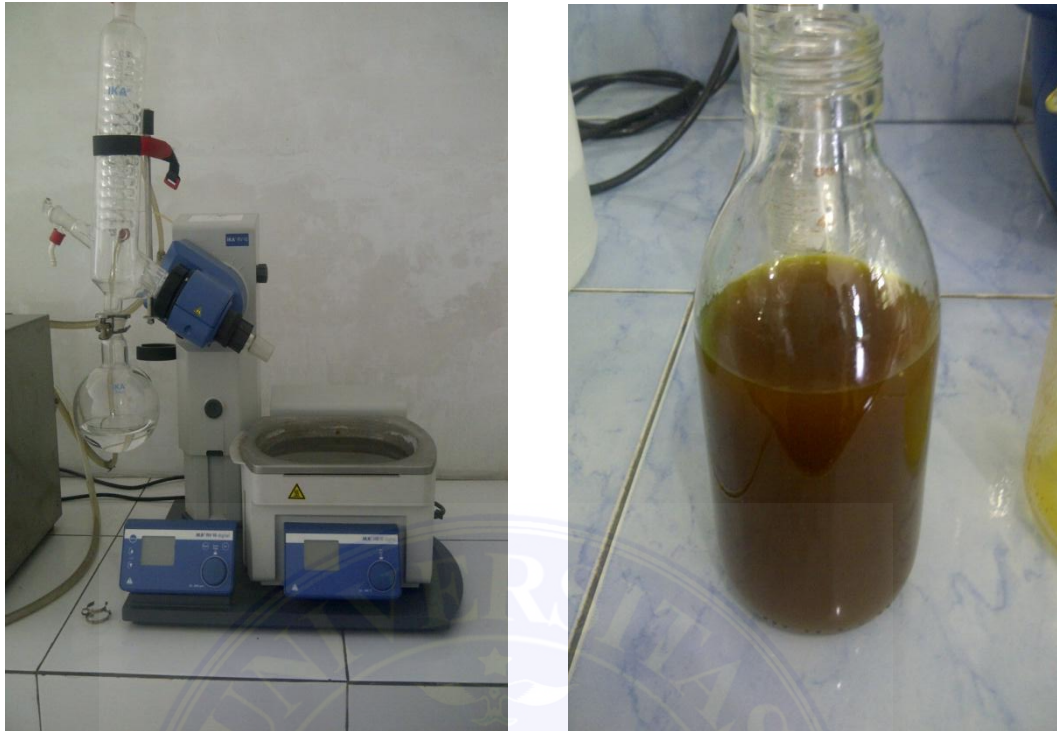
Gambar 11 : (kiri) Alat Rotary Evaporator yang digunakan untuk mengekstraksi ekstrak bunga T. diversifolia ; (kanan) hasil ekstraksi bunga T. diversifolia
