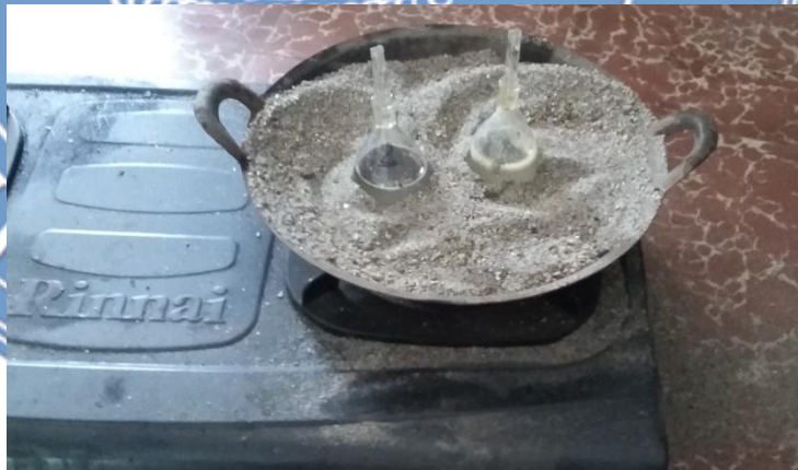
Gambar 3.2. Uji berat jenis tanah ( specific gravity )
