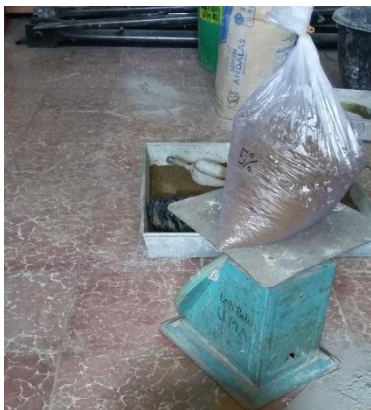
Gambar. Pengujian Standart Proctor & Kepadatan Modified Di Laboratorium UMA
