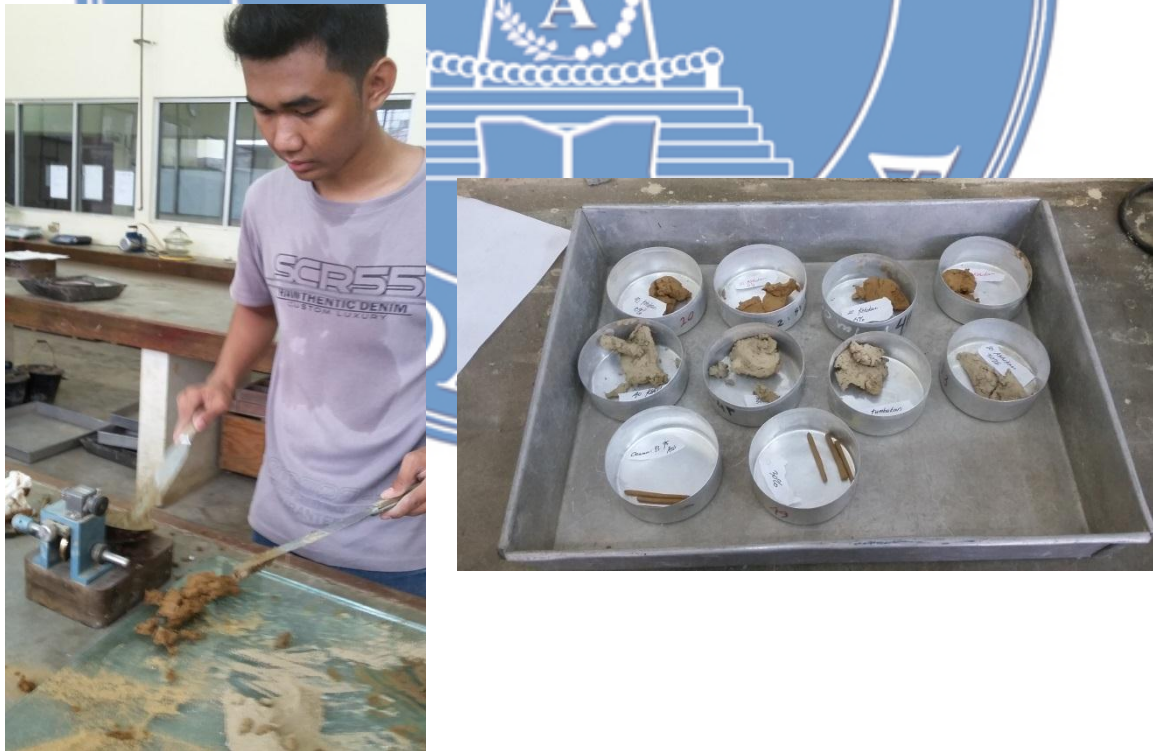
Gambar. Persiapan Benda Uji dan Sampel pengujian Atterberg Limit Di Polmed
