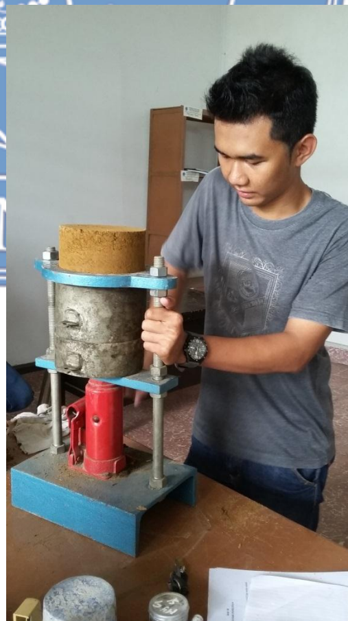
Gambar. Pengujian Standart Proctor & Kepadatan Modified Di Laboratorium UMA
