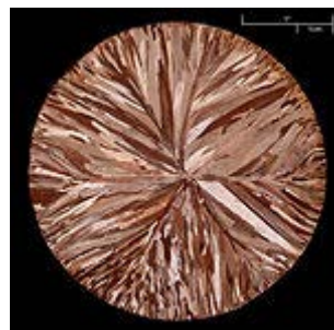
Gambar 2.3 cakram tembaga (kemurnian 99,5%) dibuat dengan continuous casting dan etching
