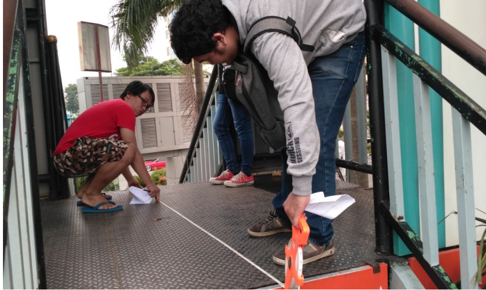
Lampiran Gambar : Pengukuran Lebar Badan Jembatan di Depan Yuki Simpang Raya
