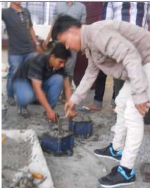
Memasukkan beton segar ke cetakan kubus
