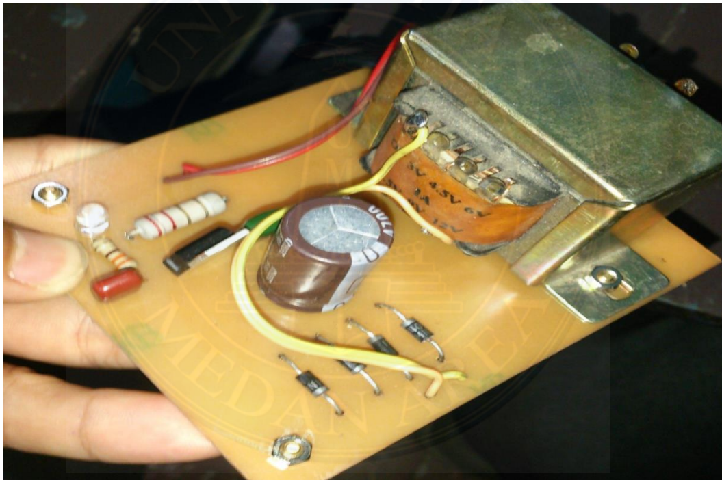
Gambar 3.9 Power supply atau rangkaian catu daya yang telah dibuat
