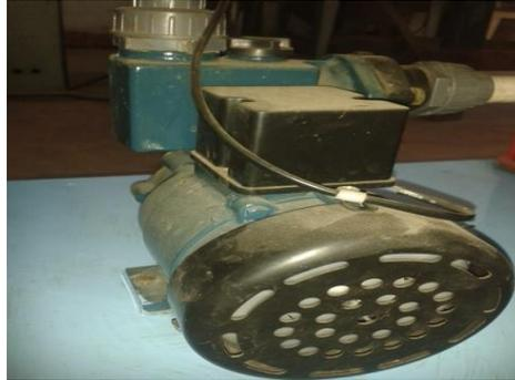
Gambar 3.9 Pompa Sentrifugal
