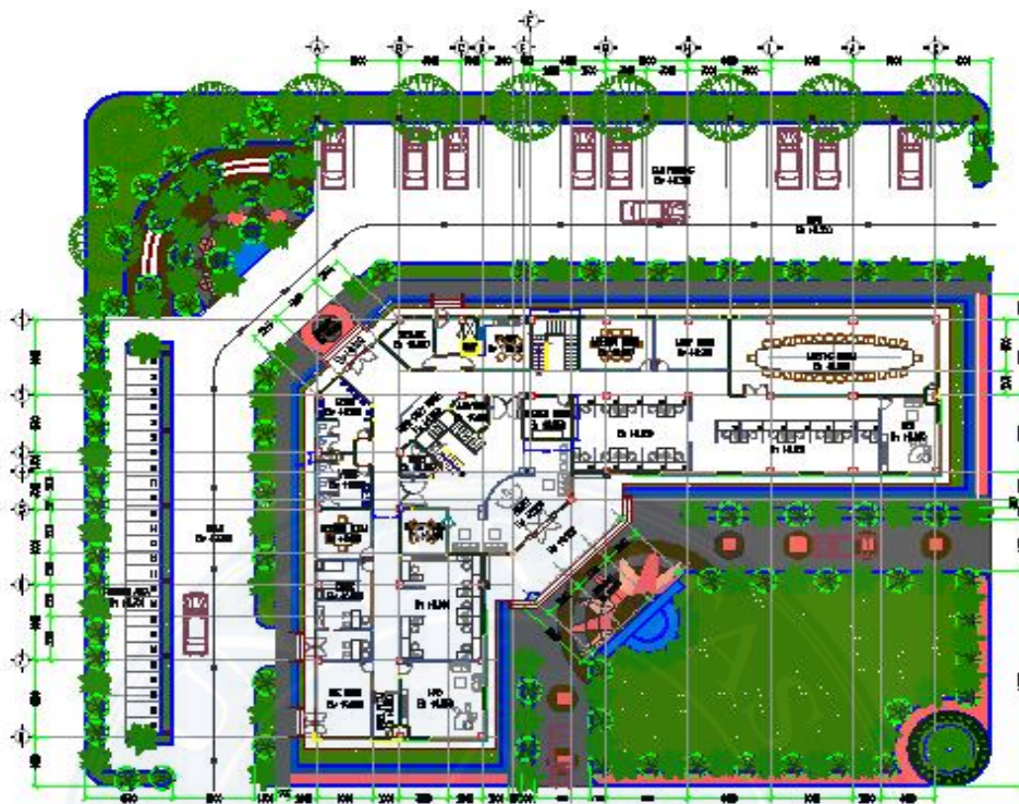
Gambar 3.1. Denah Lantai Dasar Gedung Studi Kasus
