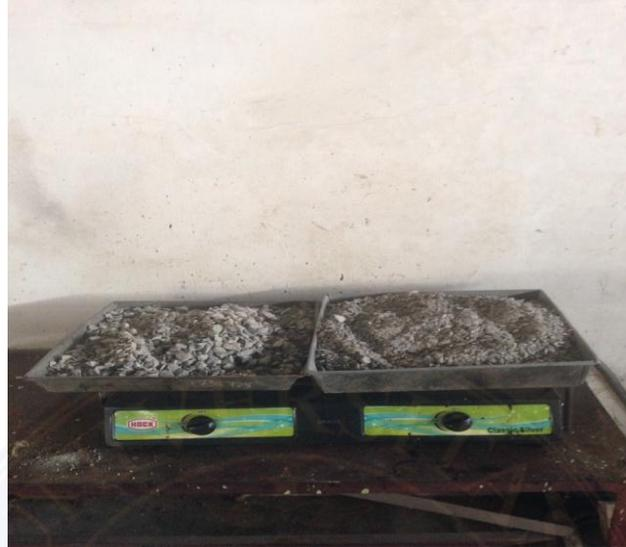
Mengeringkan benda uji dengan cara dipanaskan dengan kompor gas
