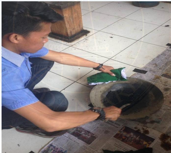
Agregat yang sudah dicampur dengan aspal dipanaskan lagi dengan suhu 150 °C
