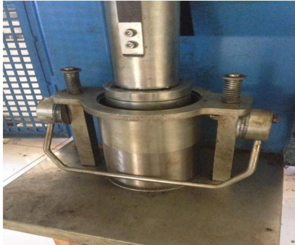
Memadatkan benda uji yang sudah dipanaskan dengan alat hammer test
