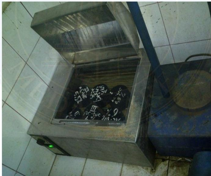
Benda uji direndam didalam water bath sebelum di uji dengan marshall test
