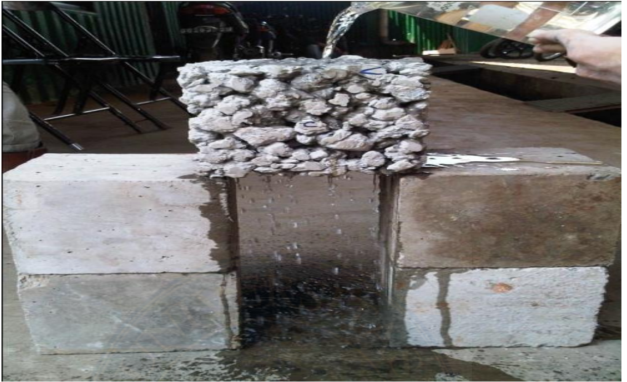
Pengujian permeabilitas air
