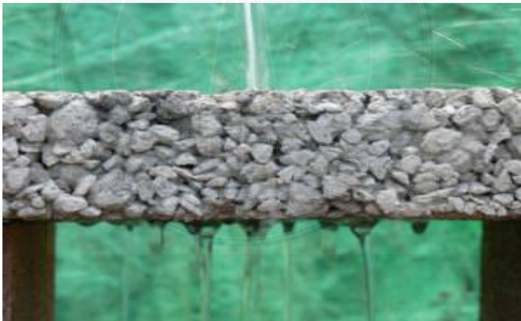
Pengujian permeabilitas air
