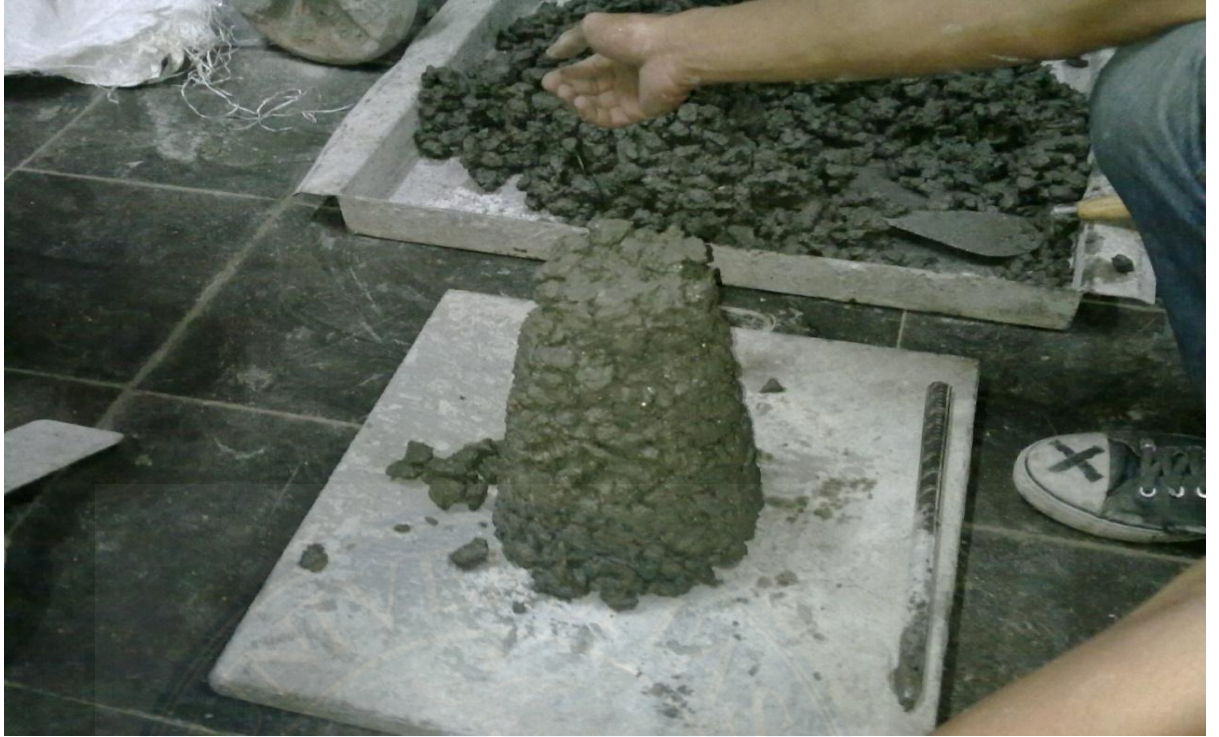
Pengujian Nilai Slump
