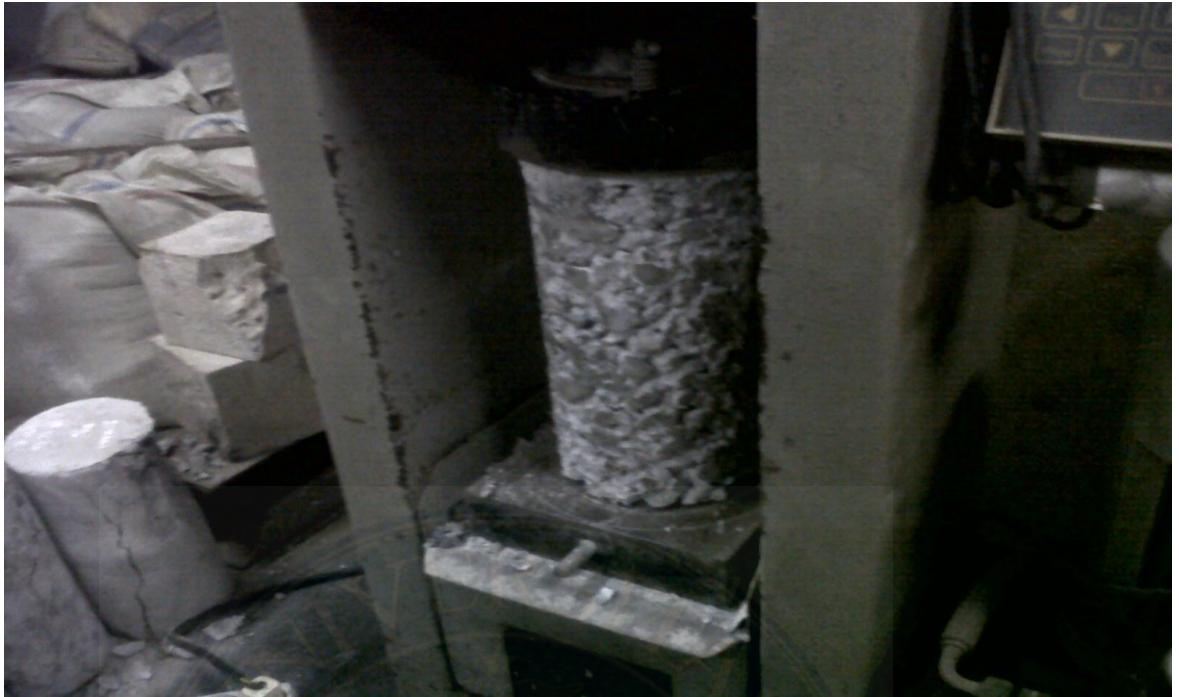
Pengujian Kuat Tekan Beton
