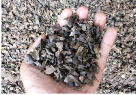
(a) Cangkang kelapa sawit sebagai sumber pembuatan aspal hayati
