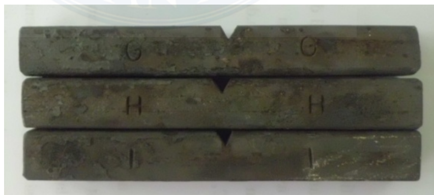
Gambar 3.19. Bahan Uji Dengan Tempering 600°C.
