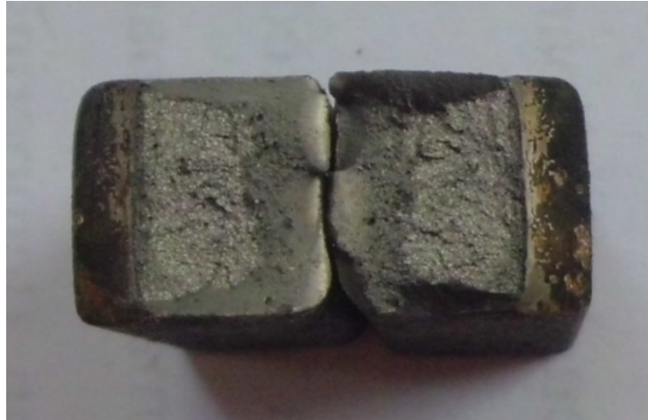
Gambar 3.37. Patahan Bahan Uji ( G ) Tempering 600°C , Tampak Atas.
