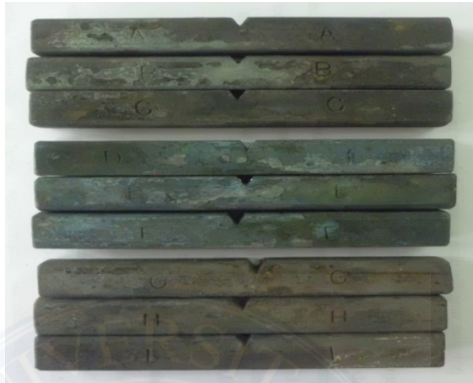
Gambar 3.16. Bahan Di Panaskan Pada Suhu 850°C.
