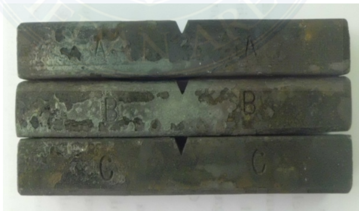
Gambar 3.17. Bahan Uji (A,B,C) Dengan Tempering 200°C
