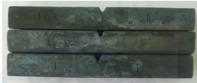
Gambar 3.18. Bahan Uji Dengan Tempering 400°C.
