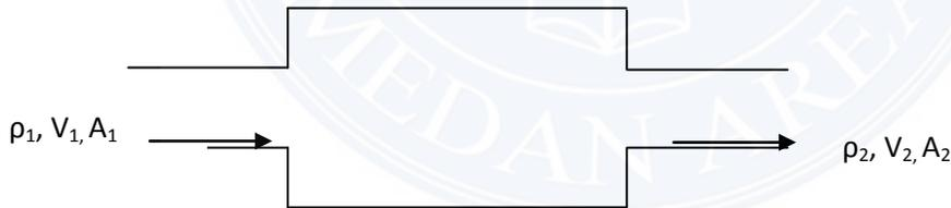
Gambar 2.12 Sebuah volume kendali dengan lubang masuk dan keluar
