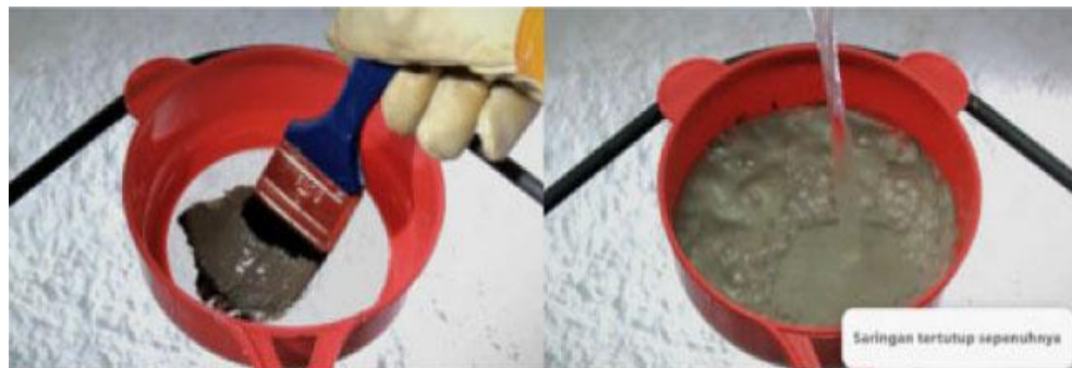
Gambar 2.6 saringan air yang dilapis damdex dapat menahan air dengan sempurna
