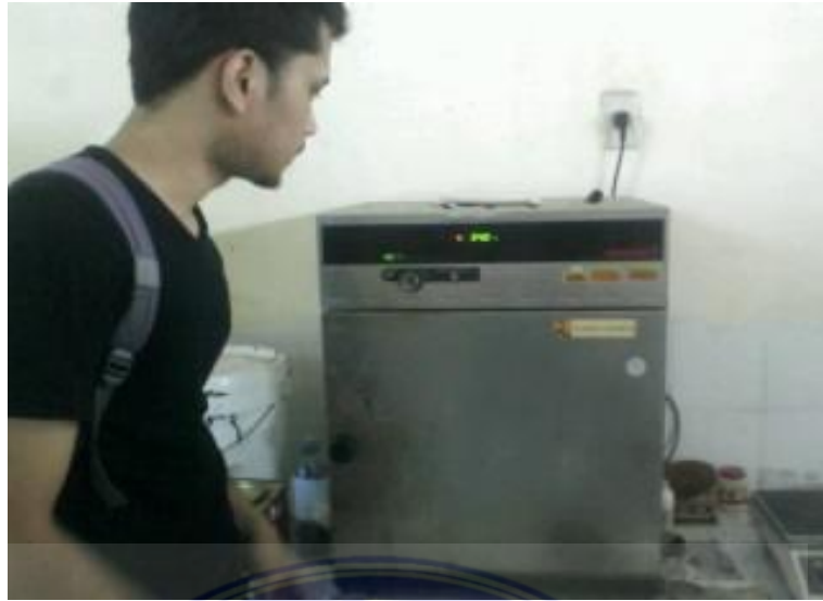
5. Mengeringkan agregat halus pasir di dalam oven
