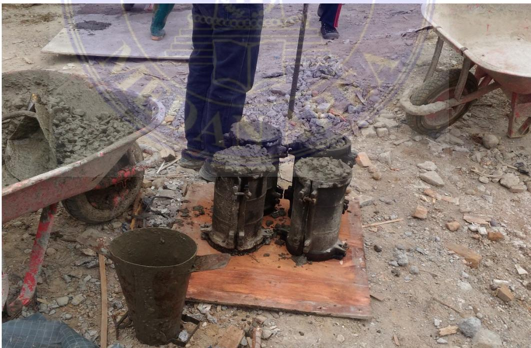
Gambar 16. Uji test mutu beton
