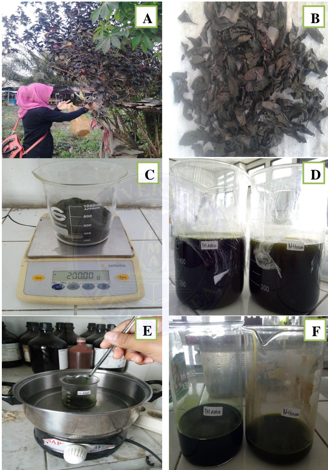
Gambar 2. Preparasi Sampel: A. Pengambilan Tumbuhan Handeuleum; B. Simplisia Daun Handeuleum; C. Serbuk Daun Handeuleum Metode sampel ; D. Ekstraksi Metode Maserasi; E. Pemekatan Sederhana; F. Ekstrak Pekat Daun Handeuleum
