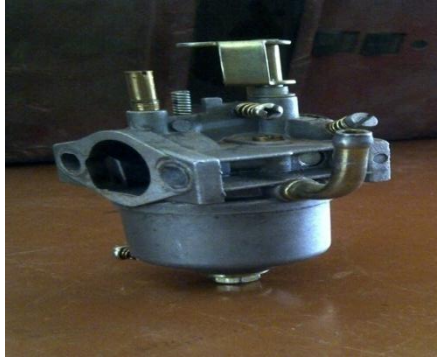
Gambar 2.17 Naple gas LPG pada karburator
