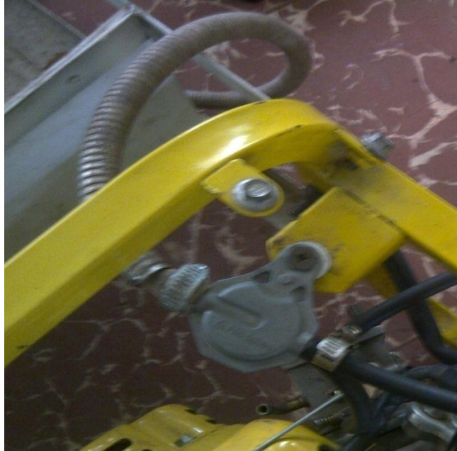
Gambar 2.18. Pemasangan Vacuum Valve
