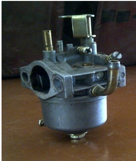
Gambar 2.9 karburator dengan penambahan nozel
