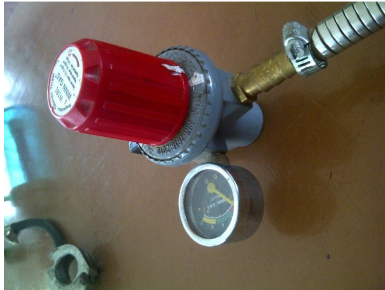
Gambar 2.5 Regulator tekanan tinggi
