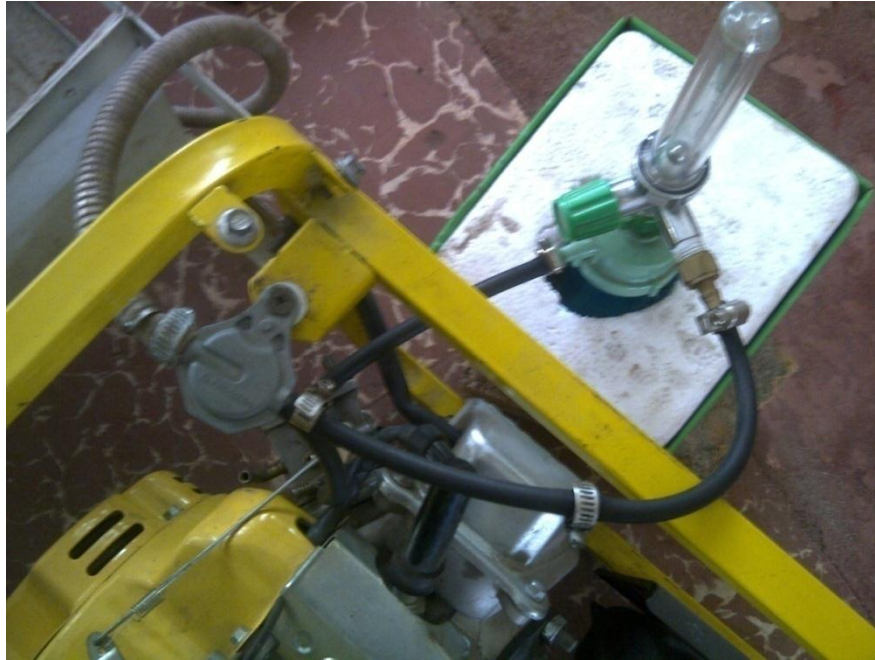
Gambar 2.20. Posisi pemasangan flow meter
