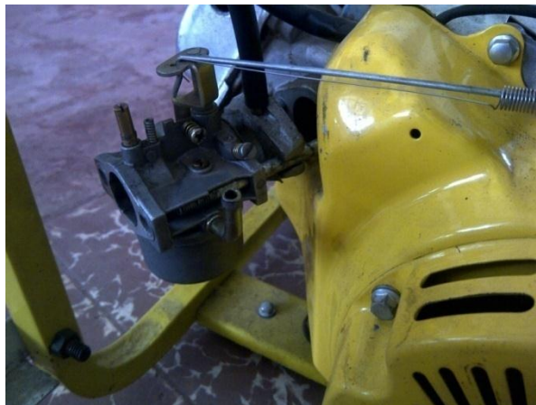
Gambar 2.15. Posisi pemasangan isolator
