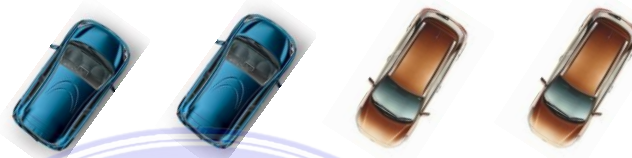
Gambar 2.2 Posisi parkir kendaraan satu sisi membentuk sudut 30^\circ, 45^\circ, 60^\circ
