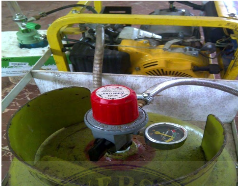
Gambar 2.20 Mesin genset dengan konverter kit yang selesai dirakit
