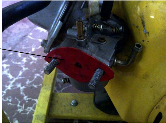
Gambar 2.19 Paking tambahan sebagai penutup mulut karburator
