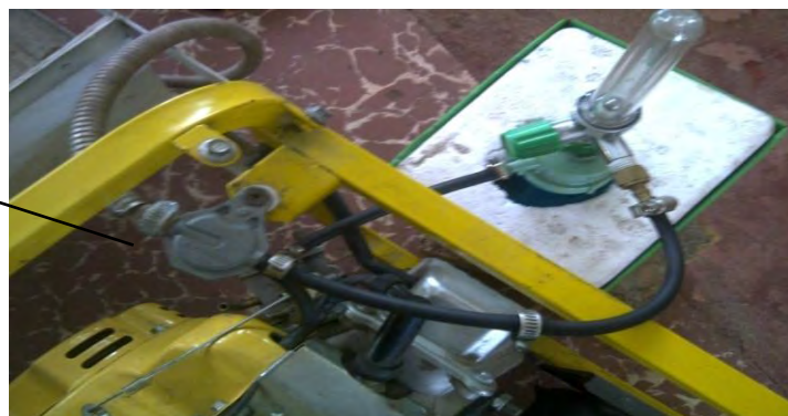
Gambar 2.12 Vacum valve terpasang pada konverter kit
