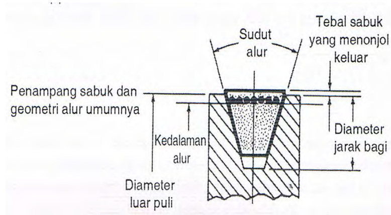
Gambar 2.7 Penampang lintang sabuk-V dan alur pully
