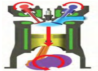
Gambar 2.1. prinsip kerja langkah hisap motor empat langkah
