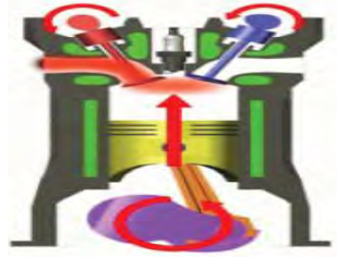
Gambar 2.4 Prinsip Kerja langkah buang Motor Empat Langkah
