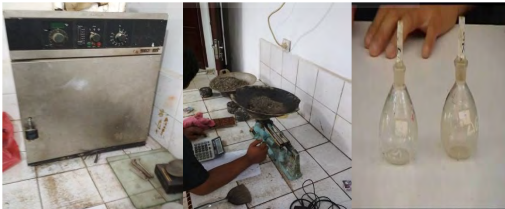
Gambar 3.9 pemeriksa agregat, timbangan dan piknometer
